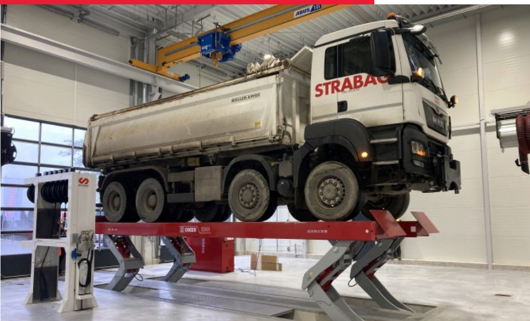
Fot. (po lewej) Podnośnik najazdowy w trakcie serwisu samochodu ciężarowego, wraz z widoczną suwnicą i linia olejowa (po prawej).
