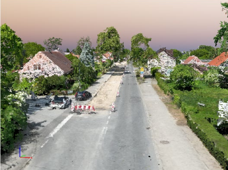
Fot. Oraz ulicy wygenerowany z chumury punktów. i ulica Głogowska w trakcie rozbudowy (po prawej).
